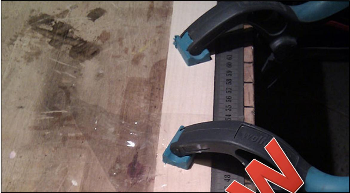
Bild 33: Zum Aushärten fixieren wir die Laminat mit Klemmzangen
