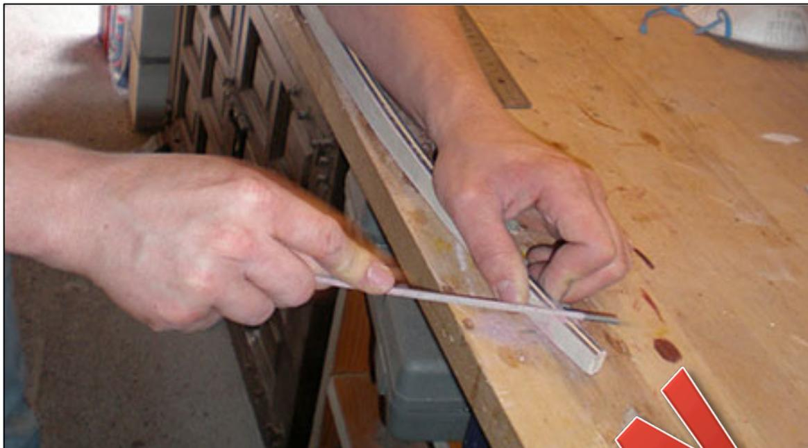
*Bild 43: Eine Kettensägefeile hat genau die passende Größe für die Sehnenkerben*
